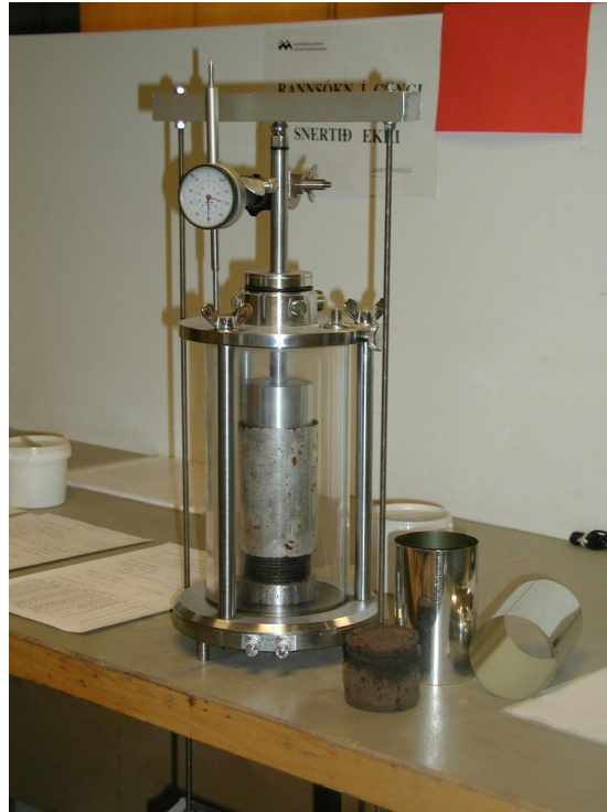
Mynd 7.4: Jarðvegssýni prófað í sérsníðuðum ödometer (Haraldur Sigursteinsson, 2010).
