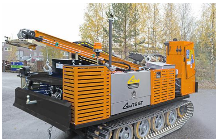
Mynd 7.1: Borvagn sömu gerðar og Vegagerðin notar í jarðvegsrannsóknir. Hann getur meðal annars framkvæmt snúnings- og þrýstiborun (Geonor, e.d.).
